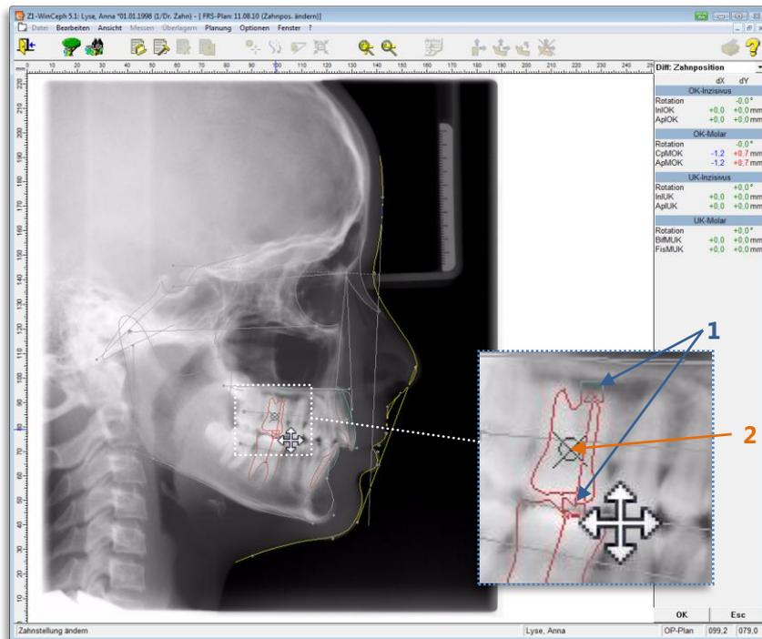
Nach Anwahl des Zahns durch linken Mausklick ändert sich sein Aussehen. Im Bereich der inzisalen/okklusalen und apikalen Messpunkte erscheint jeweils ein kleines Quadrat [1], in der Mitte der Zahnachse wird ein Kreis mit einem diagonalen Kreuz sichtbar [2], das den Rotationspunkt markiert.
