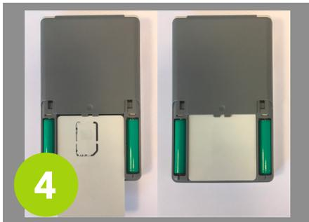
Von der Unterseite des Geräts betrachtet, wird nun die SMC-B mit der Rückseite nach oben in das Batteriefach eingeschoben. Die Kontakte müssen sich dabei im oberen Teil auf der Unterseite befinden.
