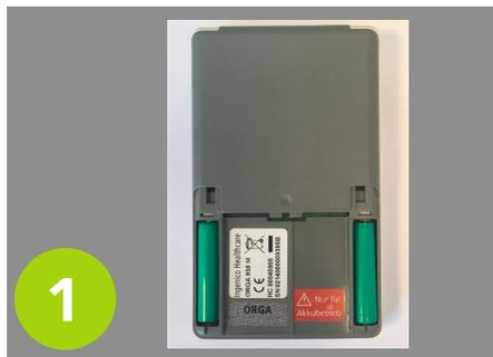
Öffnen Sie zunächst den Batteriefachdeckel des ORGA 930 M online. Legen Sie nun die mitgelieferten Akkus ein. Achten Sie dabei auf die richtige Polarität. Lassen Sie das Batteriefach offen, Sie werden es später noch einmal benötigen.
